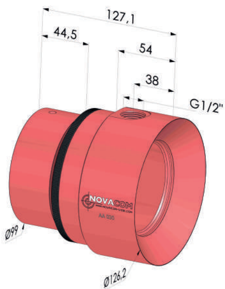
AA 030 ■ Alluminio anodizzato AA 030 ACI ■ Acciaio 316L
